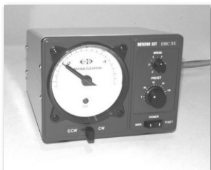
Steuergerät mit Preset und regelbarer Geschwindigkeit
